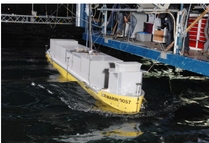
Modeltesten van een binnenschip bij een monding, in golven.
